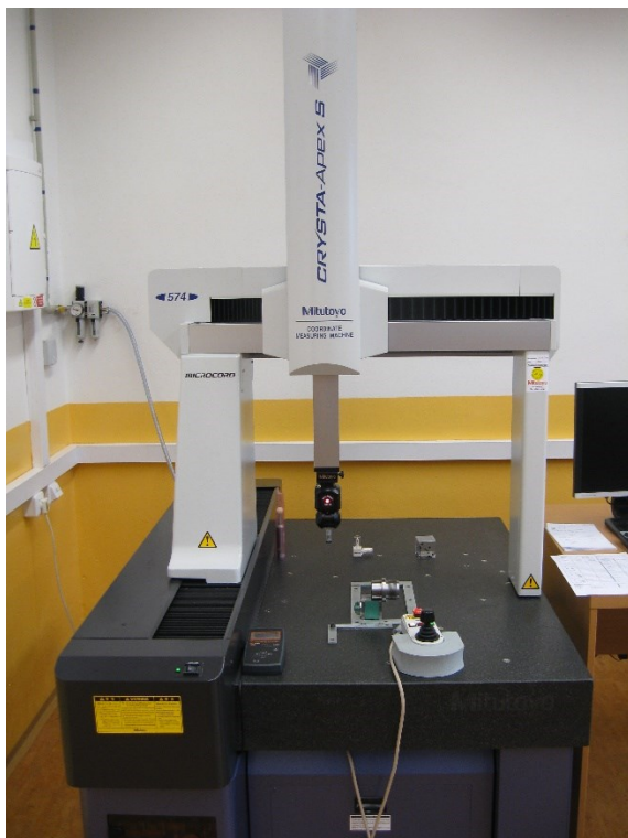
Pracoviště metrologie (CNC měřicí stroj)
