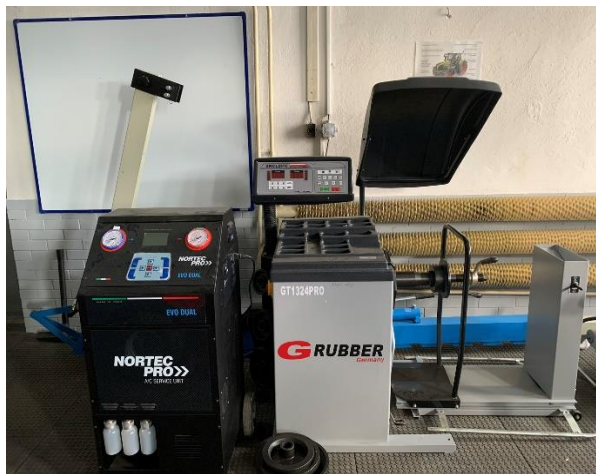
Výměna klimatizace, vyvažovačka pneumatik náklad. vozidel
